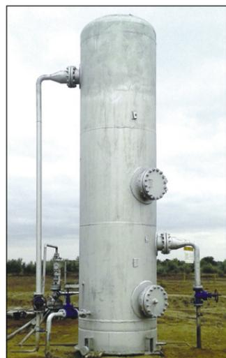
Делитель потоков на скважине 106 обеспечивает предварительный сброс пластовой воды в скважину 49 на Белокаменном месторождении.
